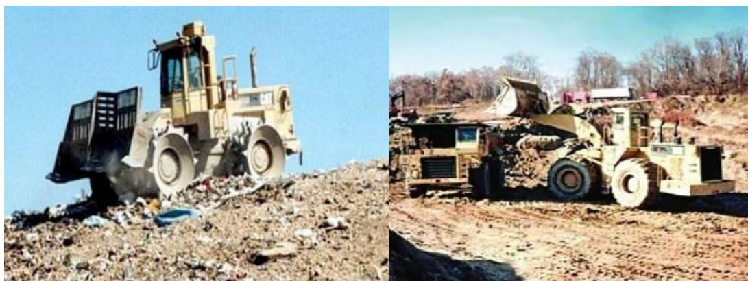
Слика 4 - 11 : Набивање на отпадот на депонијата и утовар на покривен почвен материјал
